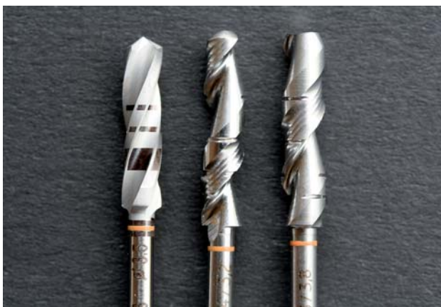
Abb. 3: Vergleich Spiralbohrer, konvexer-, konkaver HK-Bohrer.
